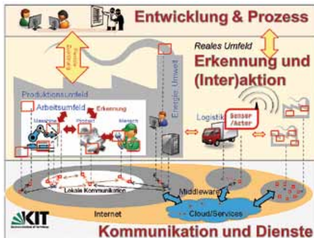
Abb. 8 – Vernetzungsmodell der Smart Factory mit dem Realen Umfeld, Quelle: Prof. Beigl, KIT 2011
